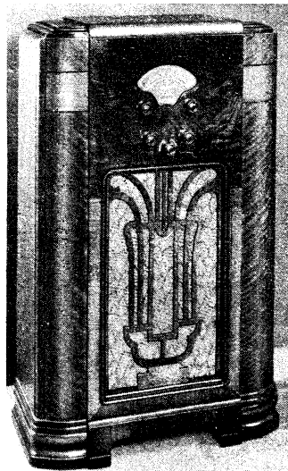
Typisch amerikanischer Schrankapparat einer der führenden amerikanischen Firmen. Arbeitet mit 9 Metallröhren. Unter der eigentlichen Einstellkala das kleine Fenster für den Schattenanzeiger zur optischen Kontrolle der Einstellhöhe. Der Knopf in der Mitte unten dient der Kontrolle der Bandbreite; Drehung nach rechts bringt bessere Tonwiedergabe, Drehung nach links schärfere Abstimmung. Werkphoto.
